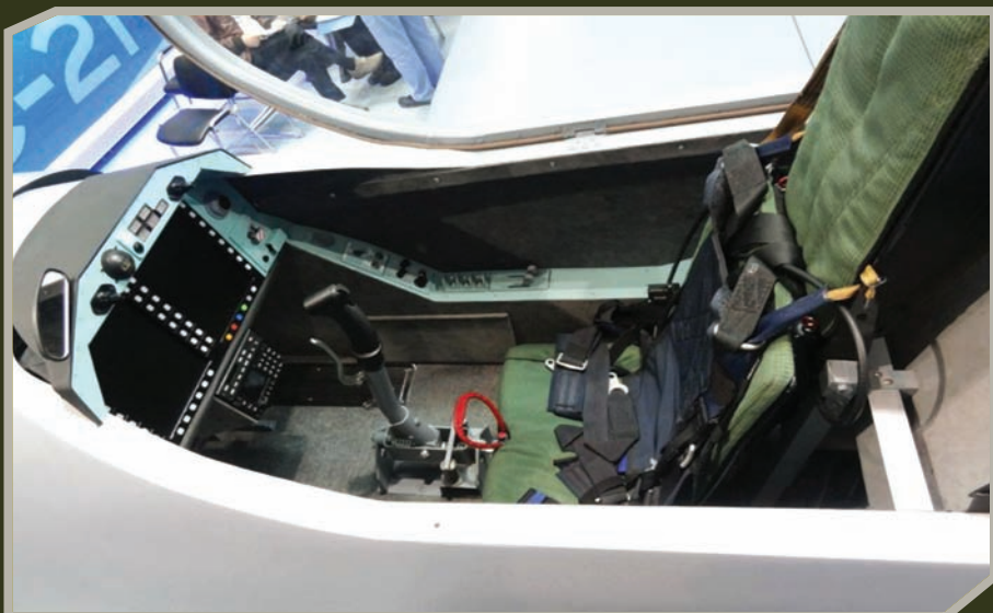
Централно место у кабинском простору Јак-152 заузима изабациво седиште СКС-94М и вишефункционални показивачи ТАС-84
