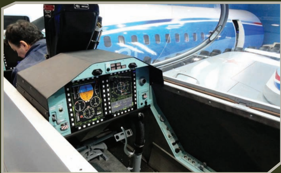
Централно место у кабинском простору Јак-152 заузима изабациво седиште СКС-94М и вишефункционални показивачи ТАС-84
